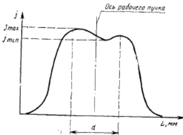
$J$  — плотность покернения пленки;  $L$  — расстояние на пленке в направлении фотометрирования, мм;  $d$  — размер поля облучения, мм
