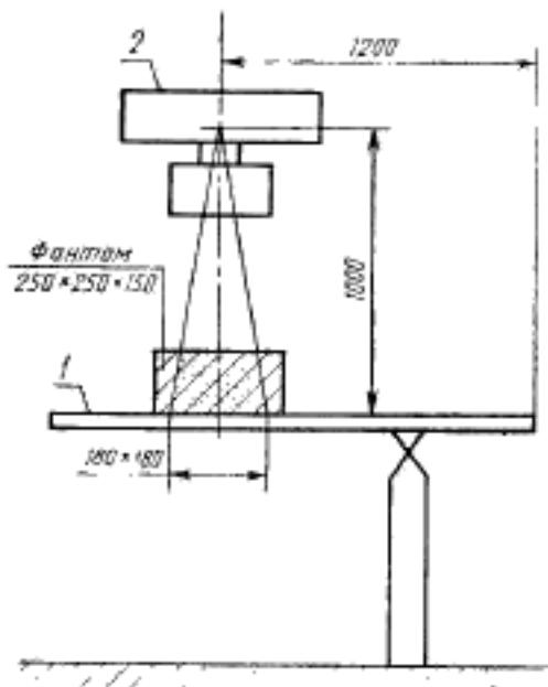
1—стенка поворотного стола-штатива; 2—рентгеновский излучатель.
