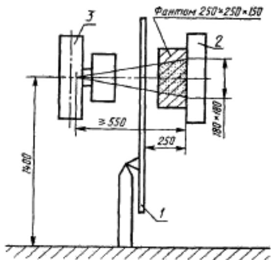
1—опорная стойка поворотного стола штатива; 2—экрано-снимочное устройство; 3—рентгеновский излучатель.
