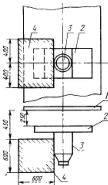
1—опорная стойка поворотного стоящего штатива; 2—экрано-снимочное устройство или экранодержатель, либо панель крепления УРИ; 3—усилитель рентгеновского изображения (УРИ); 4—зона защиты.
