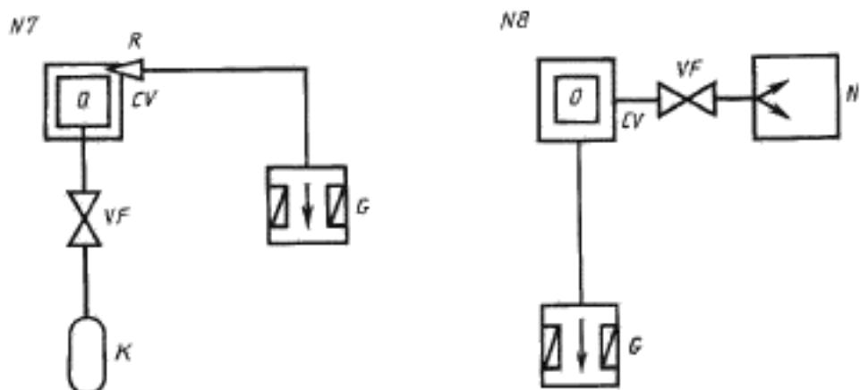
Пояснения к схемам 1—8: *O* — испытуемый объект; *G* — теченикатель; *R* — шунп, *VF* — клапан регулировочный; *N* — насос; *K* — баллон с пробным газом; *D* — обдуватель; *CV* — камера, наполненная пробным газом; *CV* — вакуумная камера
