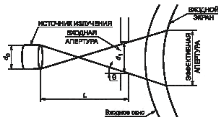
Рисунок 1 — Схема расположения ИСТОЧНИКА ИЗЛУЧЕНИЯ и ВХОДНОЙ АПЕРТУРЫ
