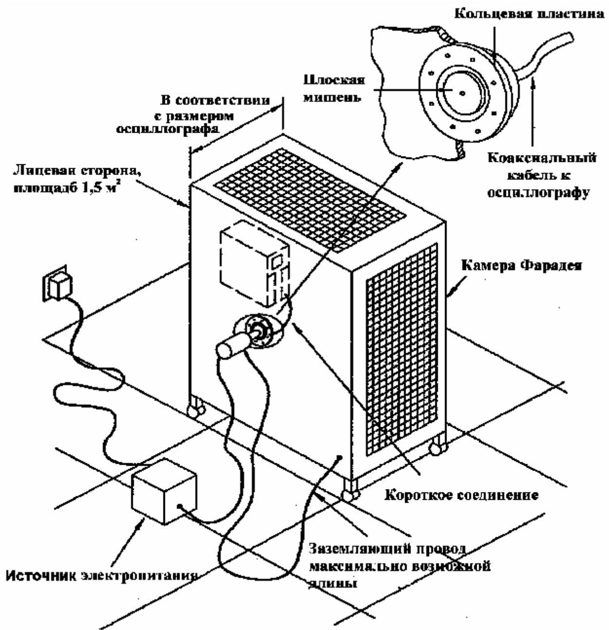
Рисунок 4 - Пример установки для контроля характеристик ИГ
