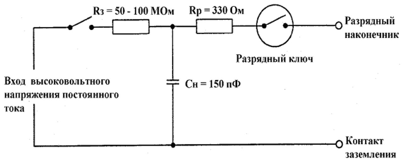
Примечание -  $C_p$ , отсутствующая на рисунке, представляет собой распределенную емкость между генератором и ИТС, пластиной заземления, пластинами связи. Поскольку эта емкость распределена по всей схеме, ее невозможно показать на рисунке.
