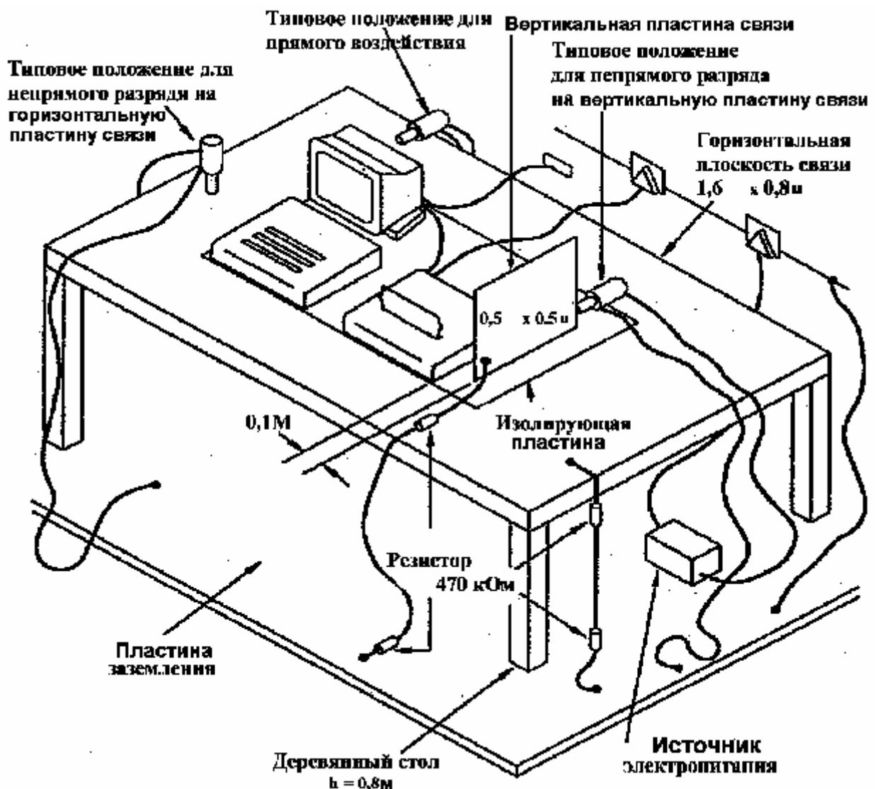
Рисунок 5 - Пример рабочего места для испытаний настольных ТС в условиях испытательной лаборатории для случая подключения вертикальной пластины связи к пластине заземления проводом с резисторами 470 кОм на каждом конце.
