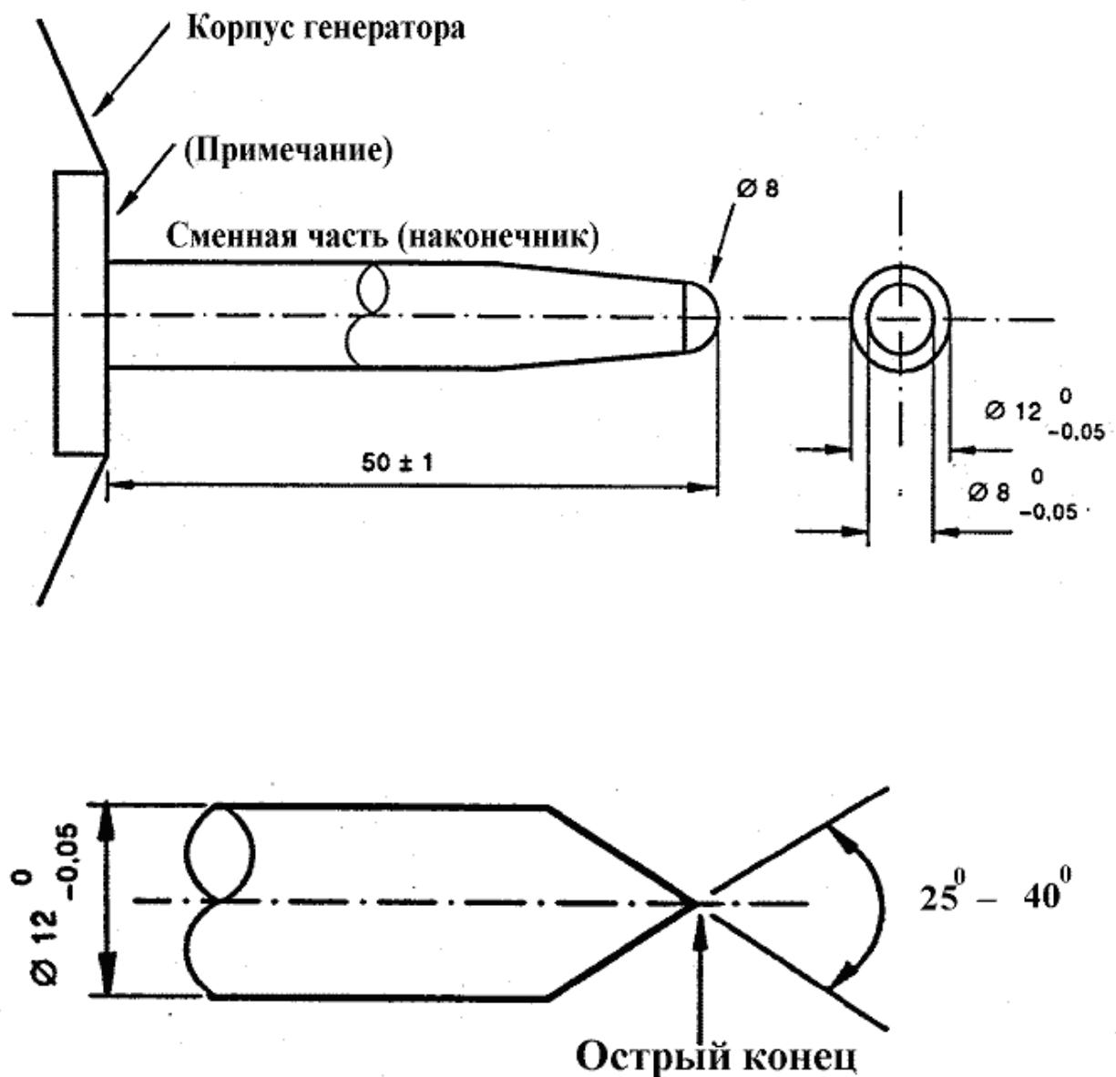
Примечание - Переключатель разряда (т.е. вакуумное реле) должен быть установлен как можно ближе к наконечнику разрядного электрода.
