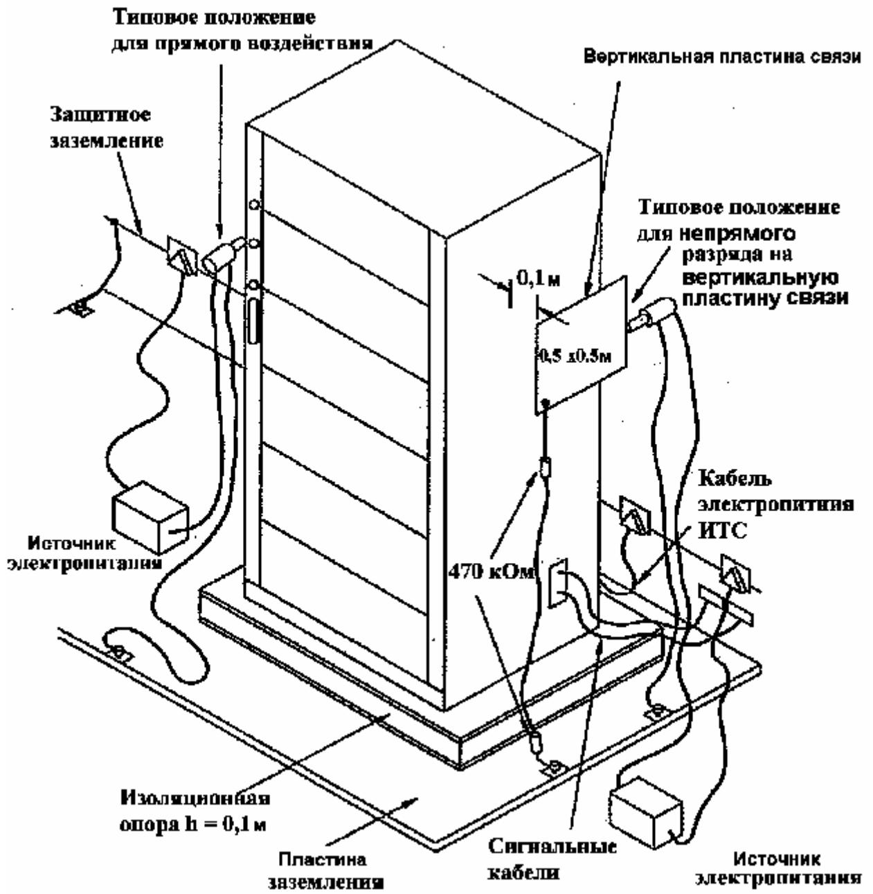
Рисунок 6 - Пример рабочего места для испытаний напольных ТС в условиях испытательной лаборатории
