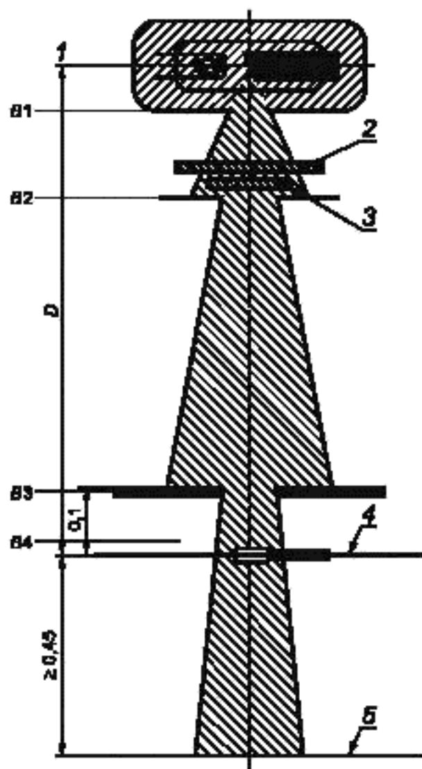
1 — диафрагмы пучка излучения ( $B_1$ ,  $B_2$ ,  $B_3$ ,  $B_4$ ); 2 — дополнительный фильтр; 3 — контрольный детектор ( $R_1$ );
