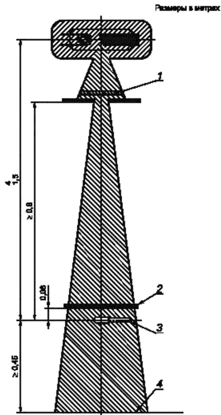
Рисунок 6 — Геометрическая схема устройства для измерения чувствительности
