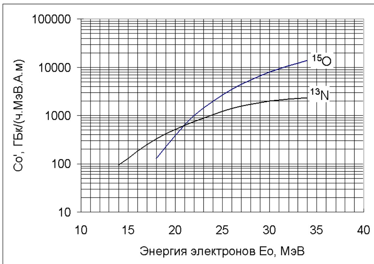
Рис. 1. Зависимость постоянной скорости образования ( $C'_0$ )
