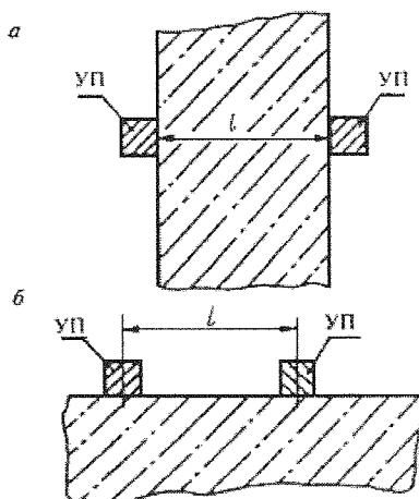
а - схема испытания бетона способом сквозного прозвучивания; б - схема испытания бетона способом поверхностного прозвучивания; УП - ультразвуковые преобразователи;  $l$  - база прозвучивания
