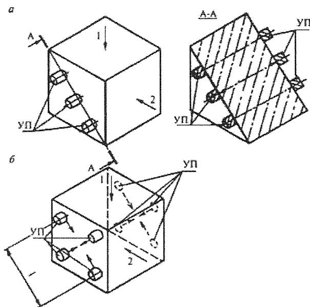
а - схема испытания кубов способом сквозного прозвучивания; б - схема испытания кубов способом поверхностного прозвучивания; УП - ультразвуковые преобразователи;
